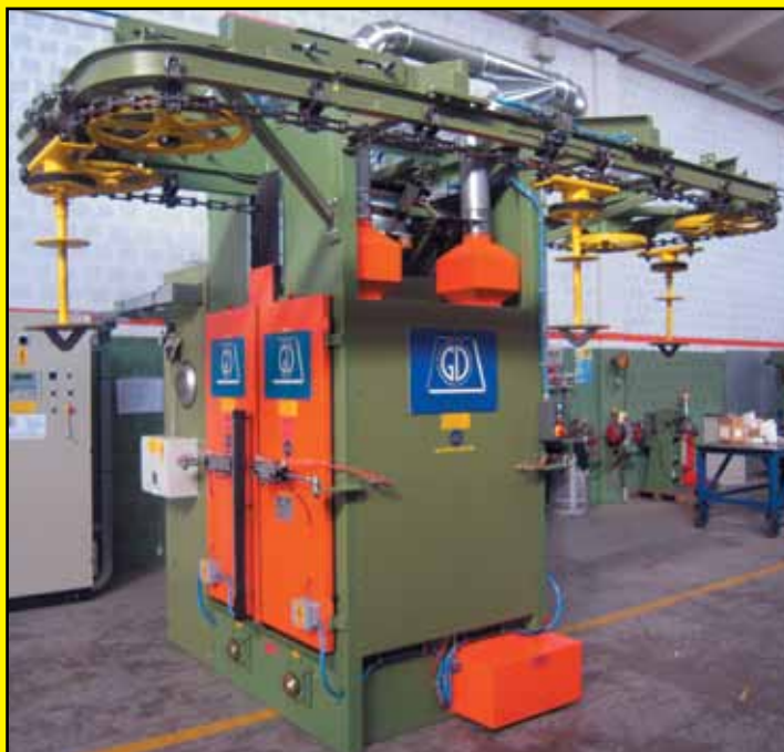
Sabbiatrice a Carichi Sospesi tipo "GD.TAC. 27/1500" in continuo a 4 carrelli
